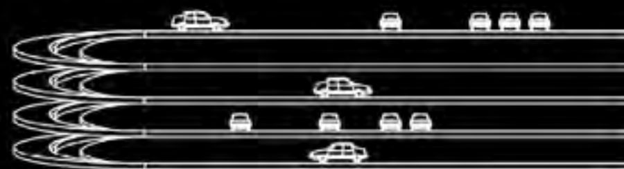
Multipiano con rampe elicoidali contrapposte esterne a doppio senso di marcia con entrata laterale
