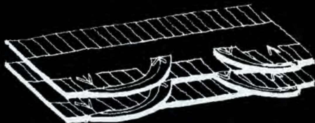
Multipiano con rampe circolari esterne a senso unico di marcia con entrata centrale
