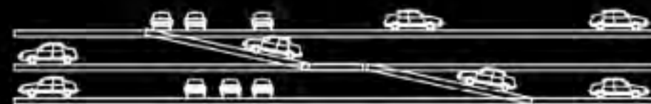
Multipiano con rampe esterne a senso unico di marcia con entrata laterale
